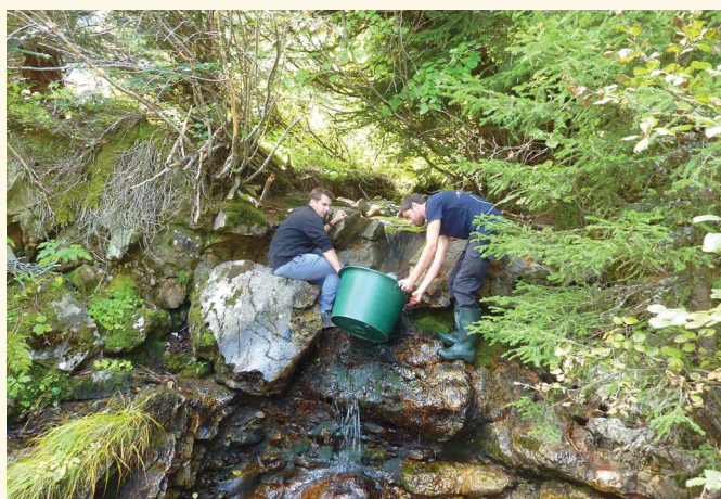
Mesure du faible débit d'un affluent du Rif Garcin pour pouvoir associer une valeur à un visuel
